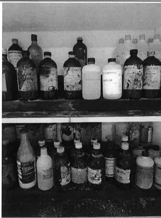
說明：藥品櫃抽氣效果不佳，造成標籤腐蝕脫落
